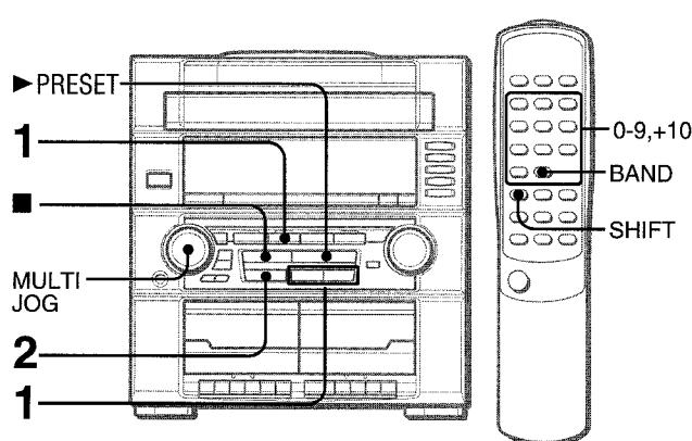
L'appareil peut stocker un total de 32 stations préréglées. Quand une station est enregistrée, un numéro de préréglage est affecté à chaque station. Utilisez le numéro de préréglage pour accorder directement une station préréglée.
